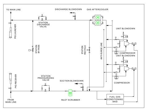
TYPICAL COMPRESSOR STATION SCHEMATIC
